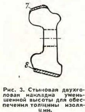
Рис. 3. Стыковая двухголовая накладка уменьшенной высоты для обеспечения толщины изоляции.
