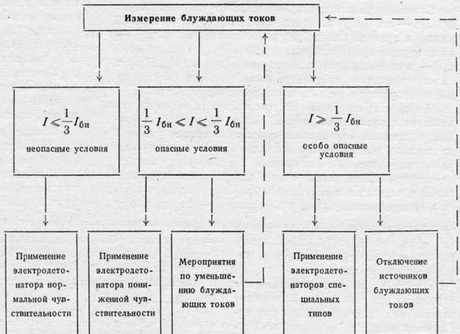
Рис. 5. Измерение блуждающих токов.
