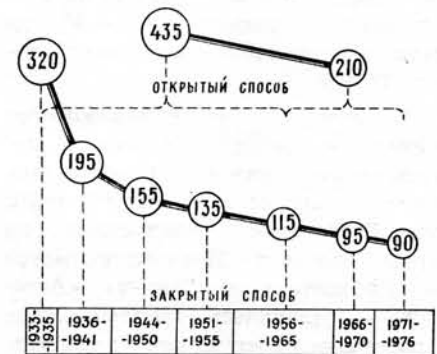
Рис. 4. Динамика снижения трудовых затрат при сооружении тоннелей.
